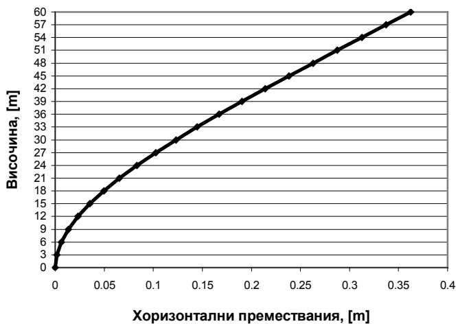
Фигура NA.4.10.5 - Хоризонтални премествания на приложените точки на масите при натоварване със силите от фигура NA.4.10.4
